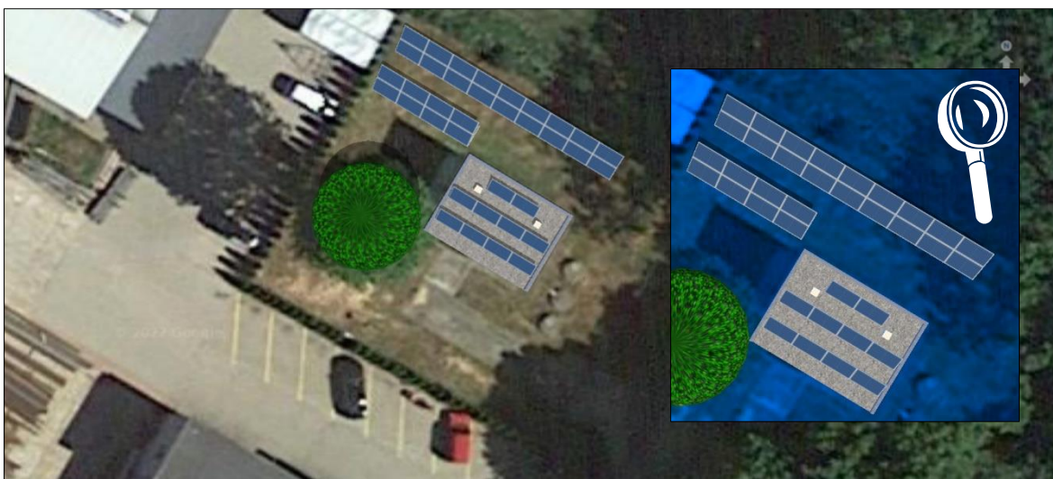
Rys. 91 Propozycja zakresu prac w ramach zamierzenia w obrębie połaci dachowych Hydroforni w Domachowie.
